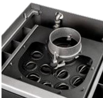
**3** L'accumulatore di calore di TERMICA (WWT9) è molto efficiente, facile da pulire dalla parte superiore della stufa.
